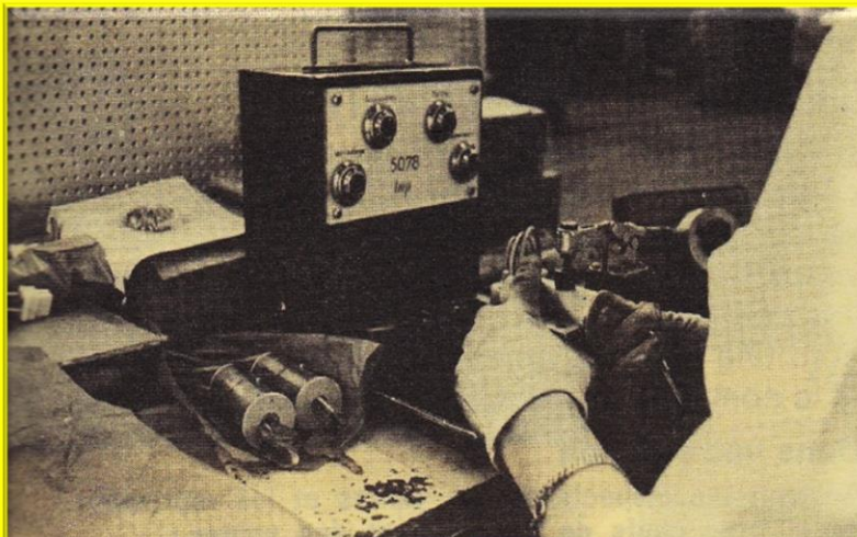
Contrôle de l'enrubannage et du fretage (antivol). La majorité des opérations de vérifications perpétuées dans les unités de production du groupe s'effectuent par comparaison à une gamme de contrôle indiquant la nature des opérations et la façon de les mener à bien.
