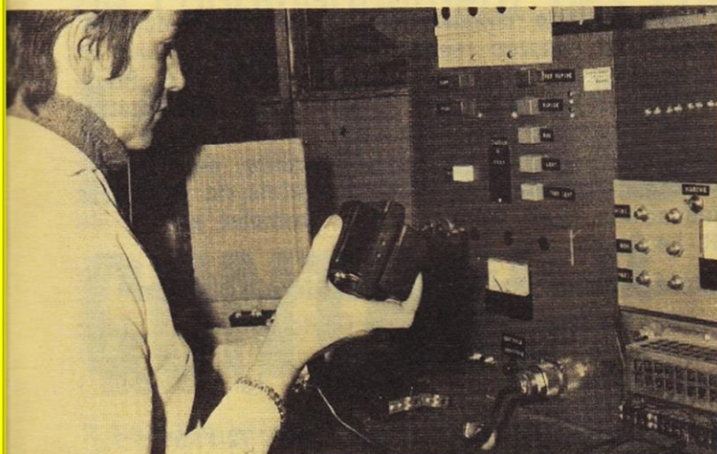
Poste de contrôle automatique des centrales clignotantes. Le cycle des opérations à effectuer est programmé. L'opératrice connecte la centrale clignotante à l'instrument de mesure et celui-ci lui fait subir tous les tests de conformité nécessaires.
